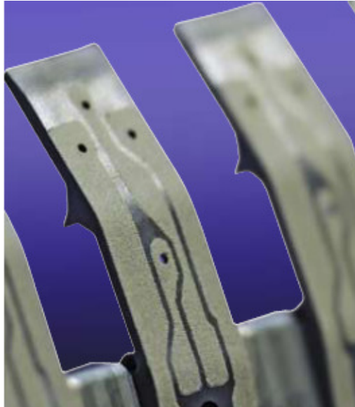
Mit Laser Direct Structuring (LDS) behandelte Oberfläche, Foto: Harting Mitronics
