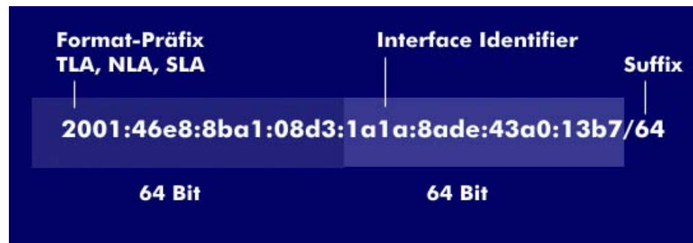
Aufbau einer IPv6-Adresse
