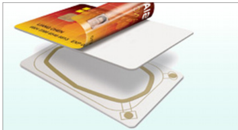
Aufbau einer RFID-Karte, Foto: youcard.de
