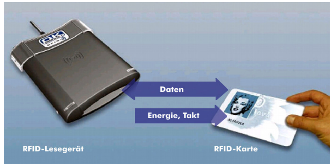
Energie- und Datenübertragung zwischen RFID-Lesegerät und -Karte
