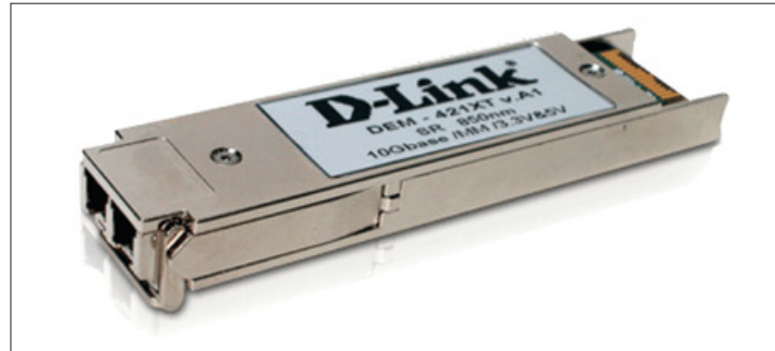
XFP-Modul mit 10GBase-SR-Schnittstelle, Foto: D-Link
