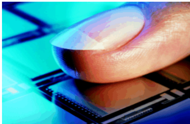
Kapazitiv arbeitender Hochleistungs-Sensor für Fingerabdrücke, Foto: Siemens
