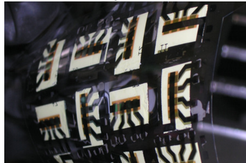
Flexible organische Solarzellen auf PET-Folie, Foto: Bosch
