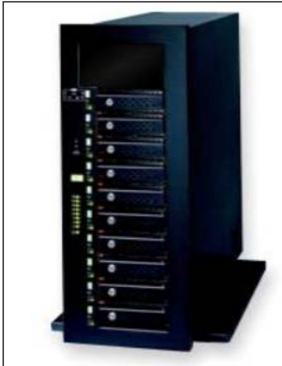
JBOD-System von Sunrise mit 10 Festplatten- Laufwerken
